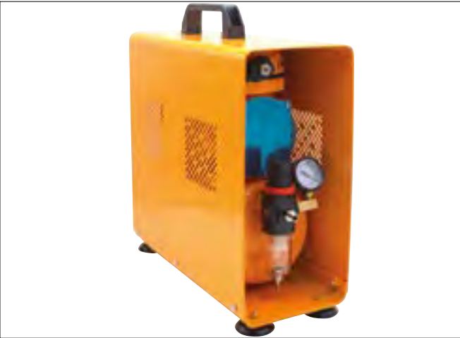
Airbrush compressor - 6 BAR Compressore per aerografo - 6 BAR Air output/Volume aria: 30-35 lt/min. Power/Potenza: 1/3 HP Voltage/Voltaggio: 220-240V 50Hz (or 120V/60Hz or 220V/60Hz). Max pressure/pressione max: 6,5 BAR/95PSI
